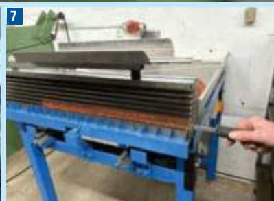
7 Behutsam wird jedes Kühlrohr in die Lamellen geschoben. Eine knifflige Arbeit
