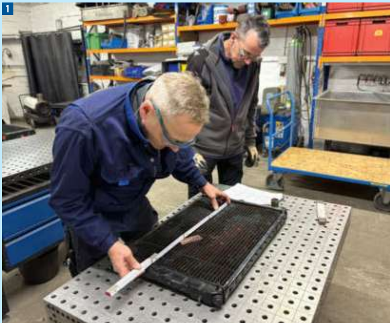
1 Exakt Aufmaß nehmen ist der elementare Start einer jeden Reparatur
